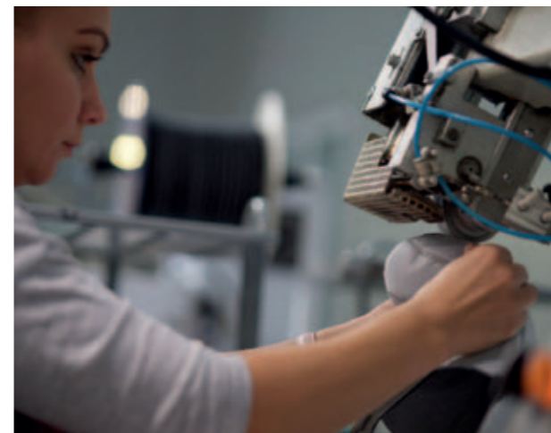
↑ Termosaldatura fodera Waterproof Aiud - Romania
